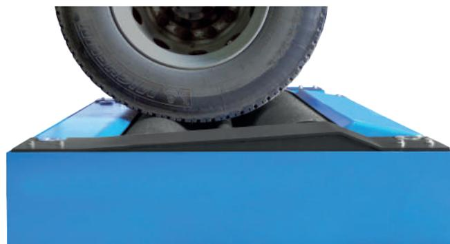
La elevación del frenómetro de pesados se lleva a cabo mediante la acción de **cilindros hidráulicos**. Un circuito oleohidráulico confeccionado con divisores de caudal permite que los bastidores se eleven de manera **sincronizada**.
